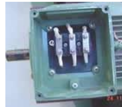
การต่อแบบเดลต้าทำให้แรงดันตกคร่อมขดลวดมีค่าเท่ากับขนาดขดลวด
