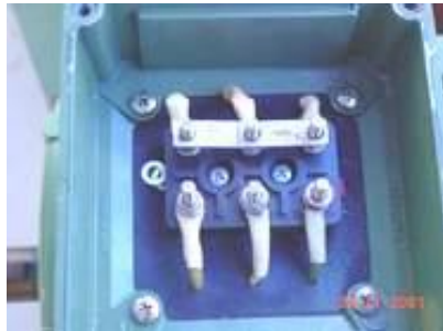
การต่อแบบสตาร์ทำให้แรงดันตกคร่อมขดลวดมีค่าต่ำกว่าขนาดขดลวด
