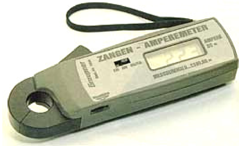
รูปที่ 10.18 แสดงโครงสร้างเครื่องมือวัดแอมมิเตอร์แบบแคลมป์
