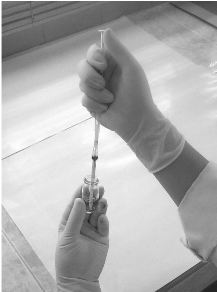
รูปที่ 9.4 ดูดย่น้ำยาเจือจางสำหรับการนับจำนวนเกล็ดเลือดถึงขีด 101 โดยจับปิเปตต์ให้อยู่ในลักษณะเกือบเป็นแนวตั้ง
