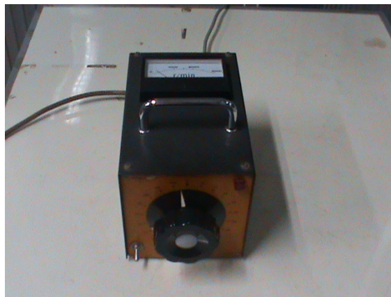
รูปที่3 แสดงเครื่องมือปรับความเร็วรอบของมอเตอร์
