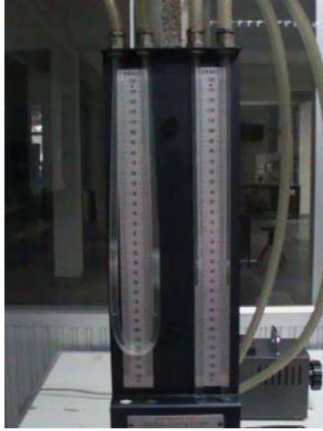
รูปที่5 แสดงเครื่องมือวัดค่าต่างระดับของความดัน(Manometer)
