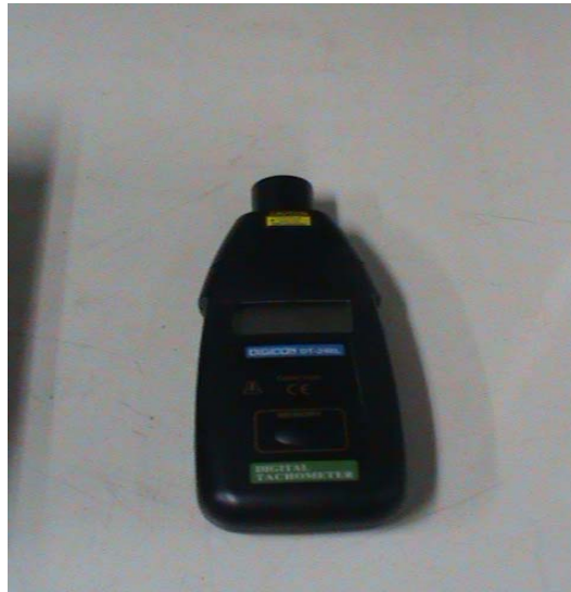
รูปที่2 แสดงเครื่องมือวัดความเร็วรอบด้วยแสง(Digital Tachometer)
