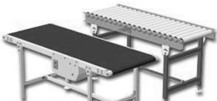
รูปที่ 2.2 สายพาน (Belt) หนึ่งในเครื่องส่งกำลัง (Bombay, 2011)
