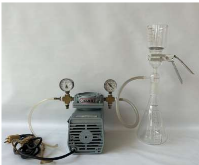
ภาพ 5.7 ชุดกรองน้ำผึ้ง (ภาพโดย สันติ แก่อินทร์)
