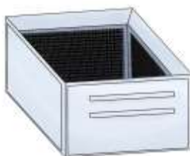
ภาพ 7.12 ถังกรองน้ำผึ้งหรือเครื่องกรอง (Strainer) (ภาพโดย พงศโชติ เบญจวัฒนานนท์)
