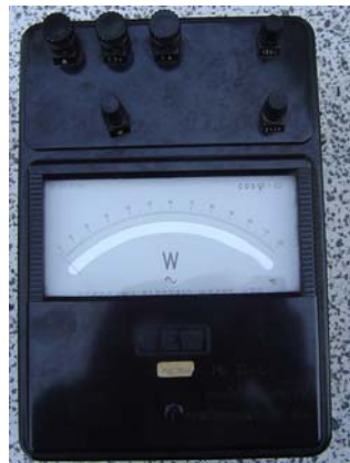
รูปที่ 10.16 แสดงการวัดกำลังไฟฟ้าสามเฟสวัตต์มิเตอร์สามเฟส
