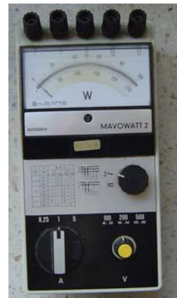
รูปที่ 10.16 แสดงการวัดกำลังไฟฟ้าสามเฟสวัตต์มิเตอร์สามเฟส
