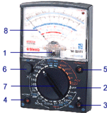
รูปที่ 10.19 แสดงโครงสร้างเครื่องมือวัดมัลติมิเตอร์แบบเข็ม
